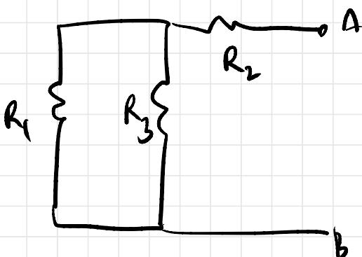
$$R_{Th} = \frac{R_1 R_3}{R_1 + R_3} + R_2$$
